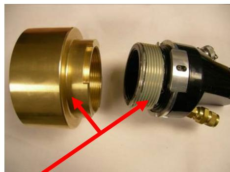
Appliquez une légère couche de graisse de silicone pour lubrifier les filetages de l'adaptateur et du capteur d'hydrophone.
